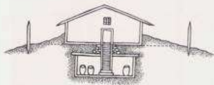
Разрез порохового погреба с чертежа крепости Кола. Начало XVIII века. Прорись автора.
