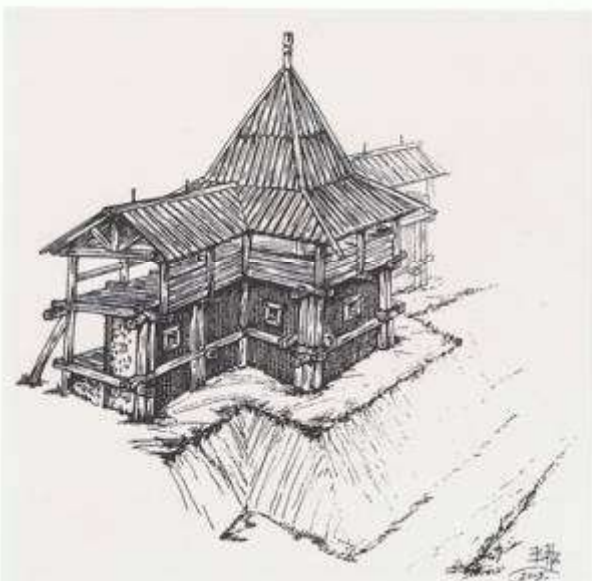
Конструкция стены Плетеного города во Мценске. Реконструкция автора.
